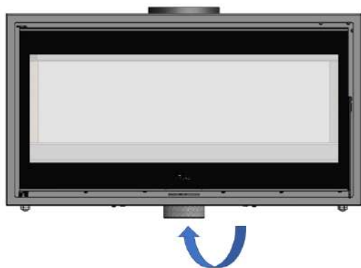
Figura n°11 - Conduzione dell'aria per camera di combustione Verona 800-1000
